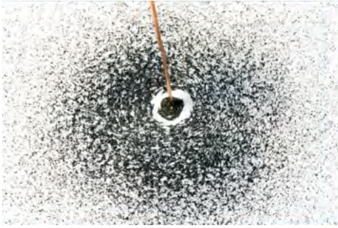
Resim 1.9: Üzerinden akım geçen düz iletken telin çevresinde demir tozları halka şeklinde dizilir.
