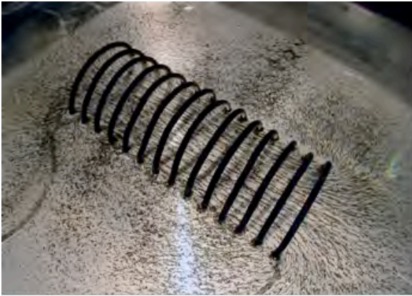
Resim 1.11. Üzerinden akım geçen akım makarasının çevresindeki demir tozlarının görünümü.
