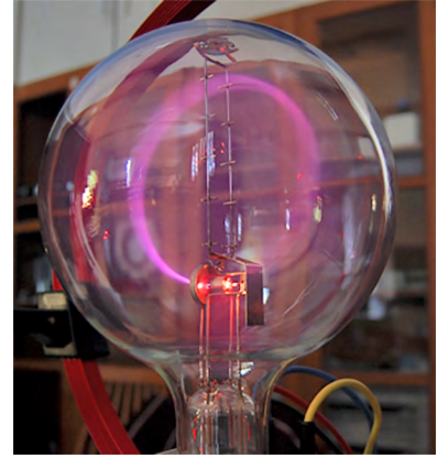
Resim 1.13. Elektron demetinin manyetik alandaki hareket yörüngesi
